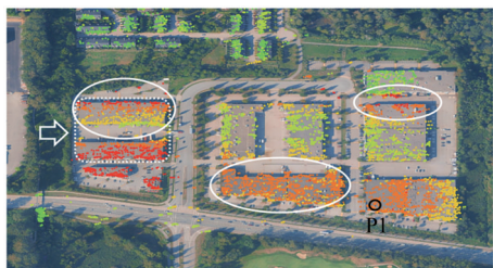
(c) 局部I处SL影像平均形变速率结果
