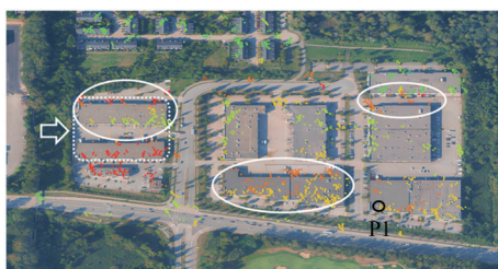
(b) 局部I处SM影像平均形变速率结果
